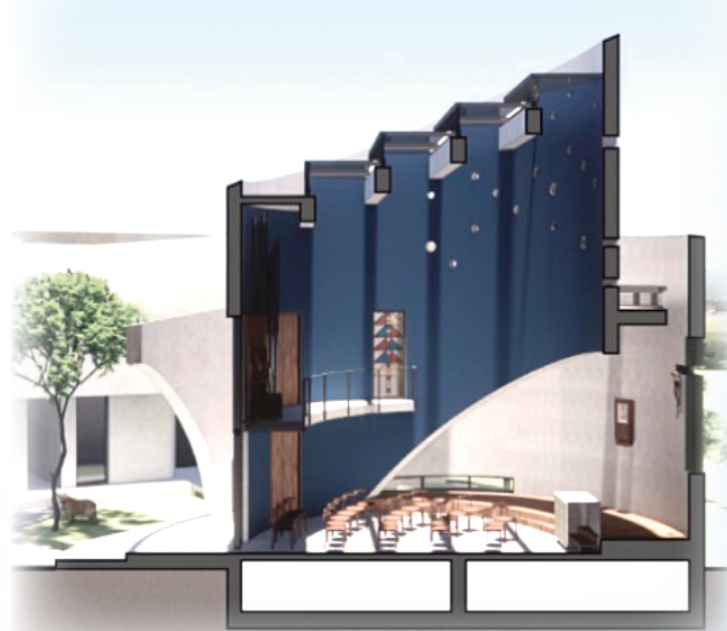
▲「眉原天主堂」建築模型內部剖面圖，簡約大方。
